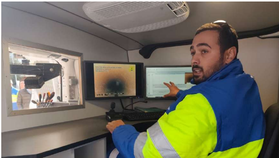
Técnico de Aqualia mostrando el sistema de cámaras utilizado para inspeccionar la red de saneamiento. Diario Más
