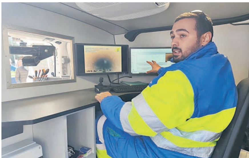
Tècnic d'Aqualia mostrant el sistema de càmeres utilitzat per inspeccionar la xarxa de sanejament. Diari Més
